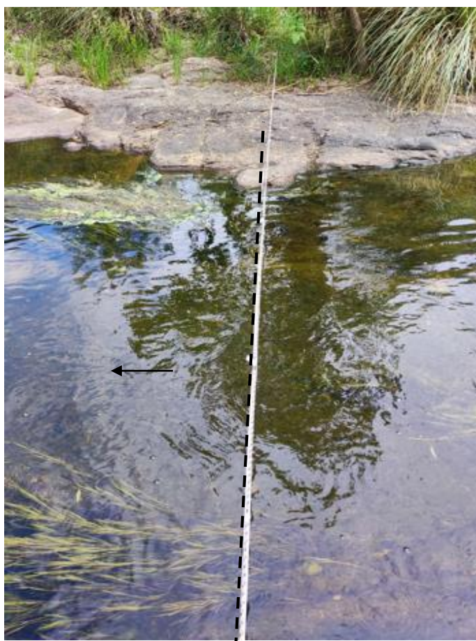
Figura A4. Aforo del arroyo Las Mojarras el día 26/03/2024. Sección de aforo
