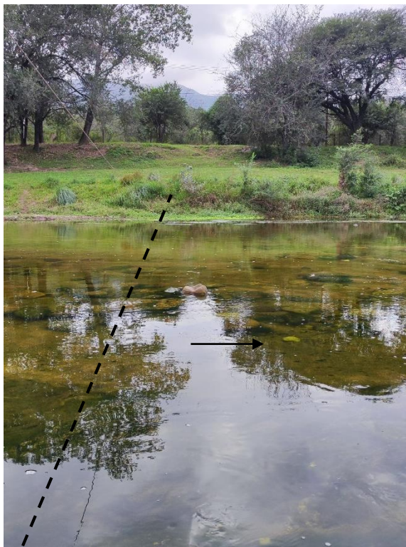
Figura A1. Aforo de río Cosquín en Villa Caeiro el día 26/03/2024. Sección de aforo, vista hacia margen izquierda
