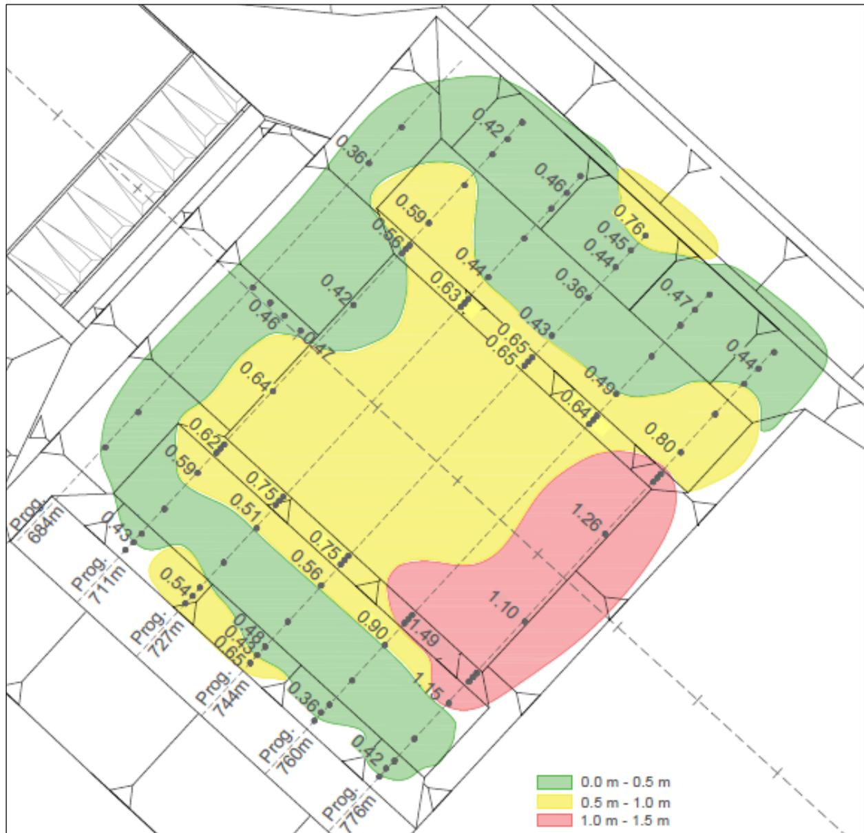
Figura 8.- Distribución de valores de RMS –  $Q = 4100 \text{ m}^3/\text{s}$ .
