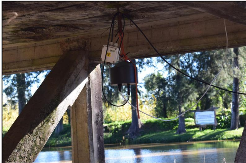
**Figura 6.-** Medición de nivel de agua mediante sensor de nivel.
