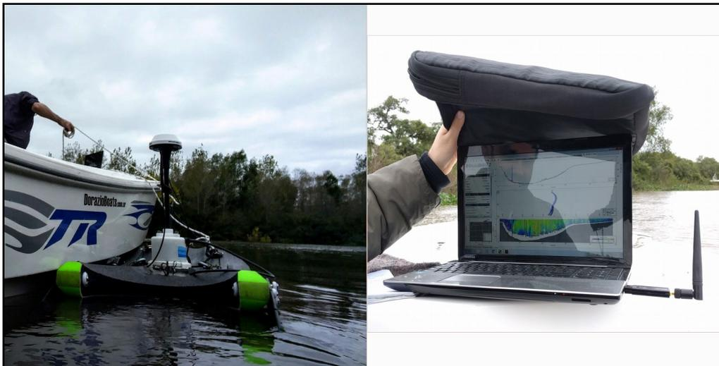
**Figura 4.-** Toma de datos batimétricos y caudal mediante dispositivo ADCP.
