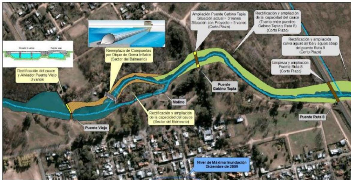
**Figura N°10-** Continuidad actual del Plan de Manejo Hídrico sobre el cauce del río Areco y los puntos de intervención proyectados.
