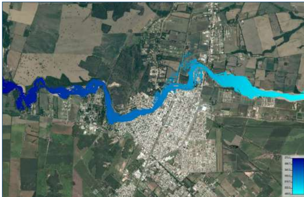
Figura V.33. Elevación máxima de la superficie de agua correspondiente a la simulación del caudal asociado a T= 100 años
