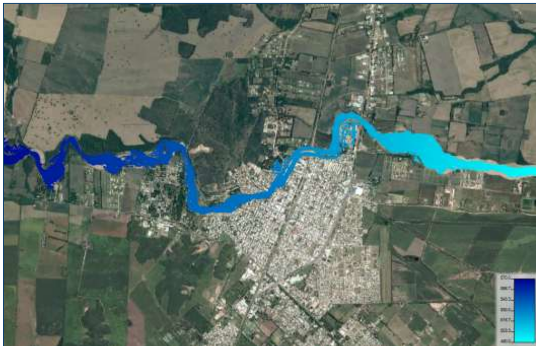
Figura V.27. Elevación máxima de la superficie de agua correspondiente a la simulación del caudal asociado a T= 10 años
