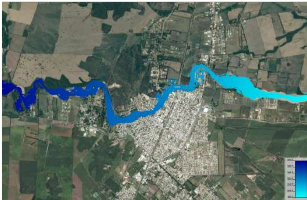
Figura V.31. Elevación máxima de la superficie de agua correspondiente a la simulación del caudal asociado a T=50 años
