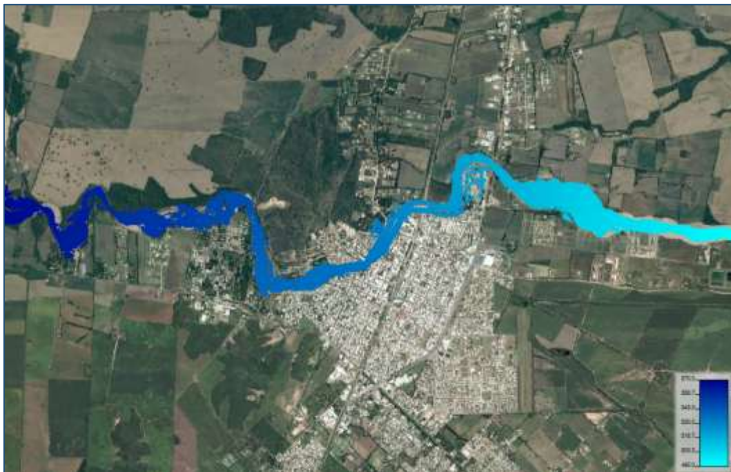
Figura V.29. Elevación máxima de la superficie de agua correspondiente a la simulación del caudal asociado a T= 25 años
