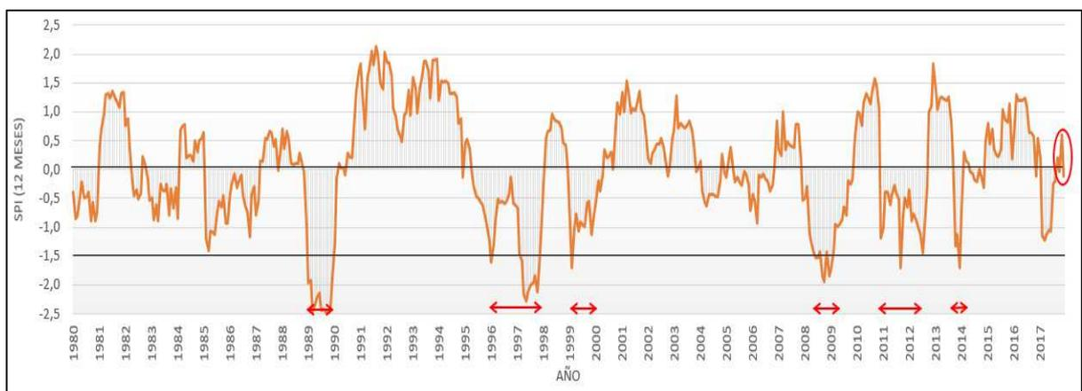
Figura 2. Índice SPI (12 meses) obtenida a partir de registros observados y estimados de TRMM, en la estación Marcos Juárez. Periodo 1980-2017. Se destacan los periodos con sequías severas y extremas.
