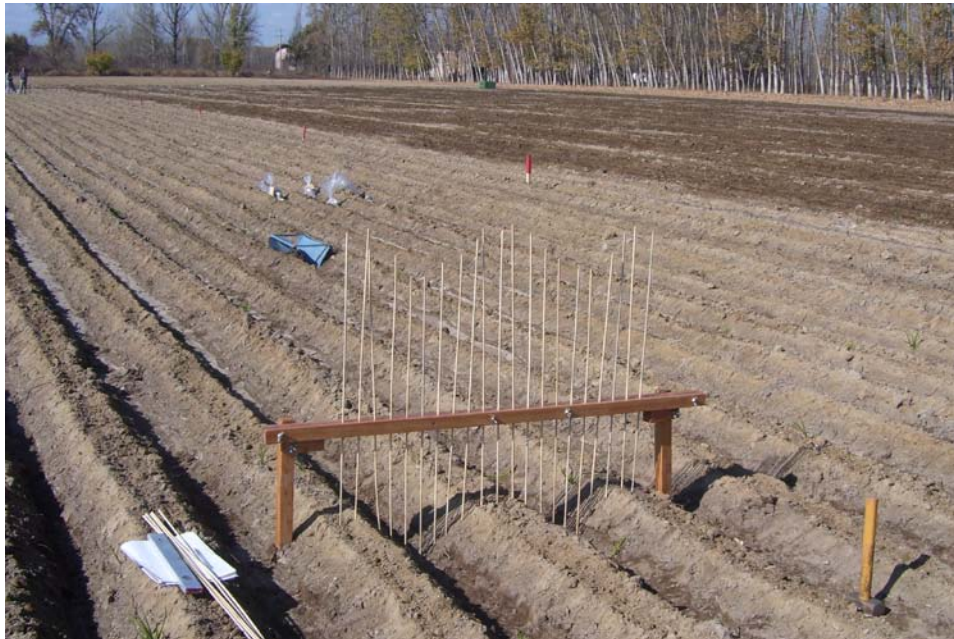
Medición del formato de surcos con perfilómetro
