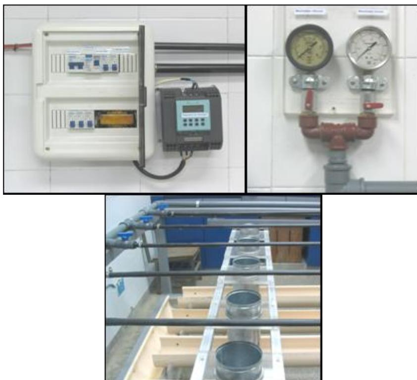
**Figura 9.- Fotografía de los sistemas de automatización regulación y control, y pluviómetros**
